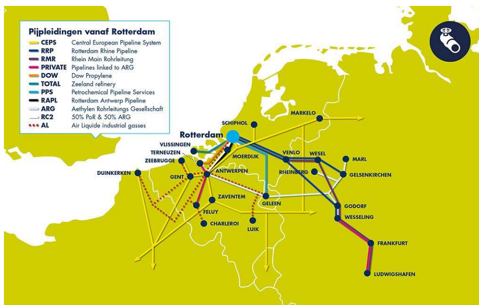
Afbeelding 9: Pijpleidingennetwerk voor industriële gassen waaronder waterstof (AL) en etheen (ARG, RC2); bron: HbR.
